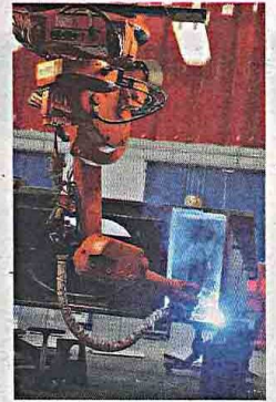
Svetsroboten gör sådant jobb som upplevs monotont och trist för en mänsklig svetsare.
